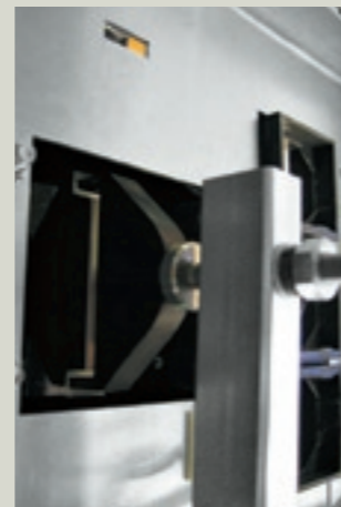
Réglage de la butée : jeu maximum 0,2 mm
