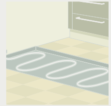
Chauffage électrique par le sol
