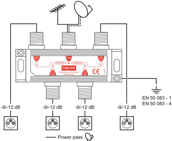
Raccorder le répartiteur télévision 4 sorties au bornier de terre du coffret
