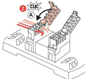
Module RC : il est conseillé d'effectuer le câblage sur la partie dénudée des fils.
