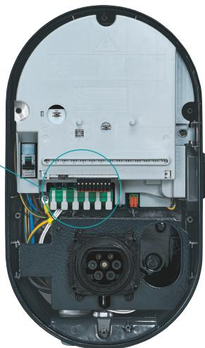
La sortie télé-information (i1/i2) du compteur Linky doit être connectée à l'entrée TIC (1/2) située sur le bornier interne à la borne de recharge
