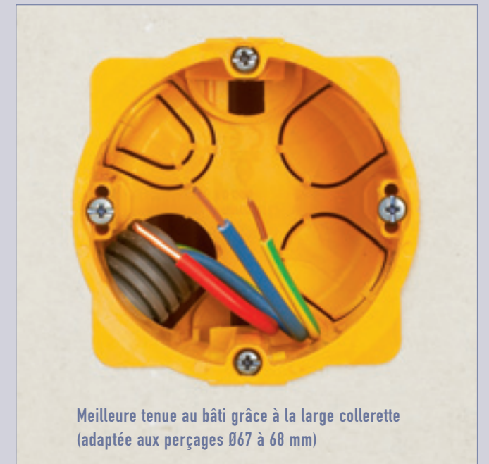
Grande amplitude de serrage des étriers (BA13 ou 2xBA13) Ils se mettent automatiquement en place lors du vissage, même avec une visseuse électrique
