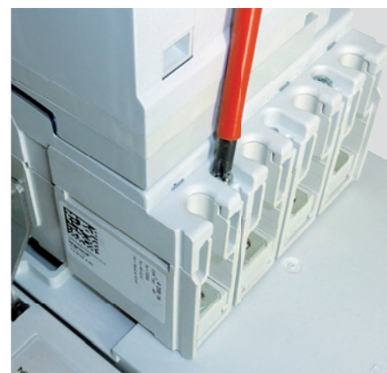
Mettre en place l'appareil sur la base puis le fixer à l'aide des 4 vis fournies avec la base (couple de serrage 1 Nm).
